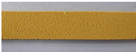
亀裂(劣化)の状態
